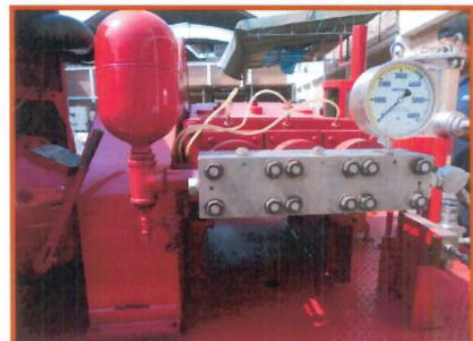
Foto 6. Inspección de cabezal de alta presión.
